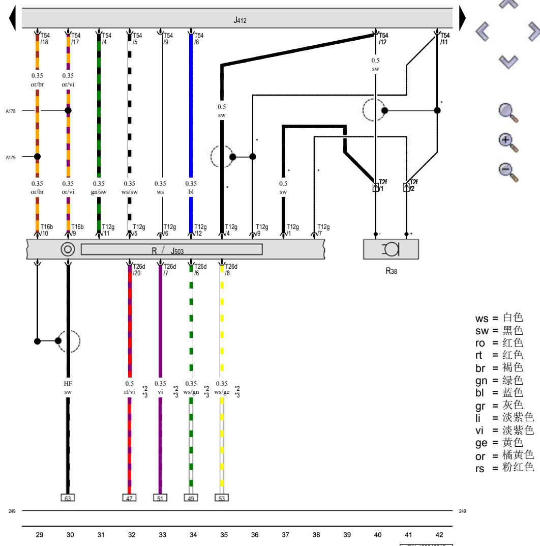
移动电话操作电子装置控制单元, 收音机及导航系统带显示单元的控制单元, 收音机, 电话话筒
