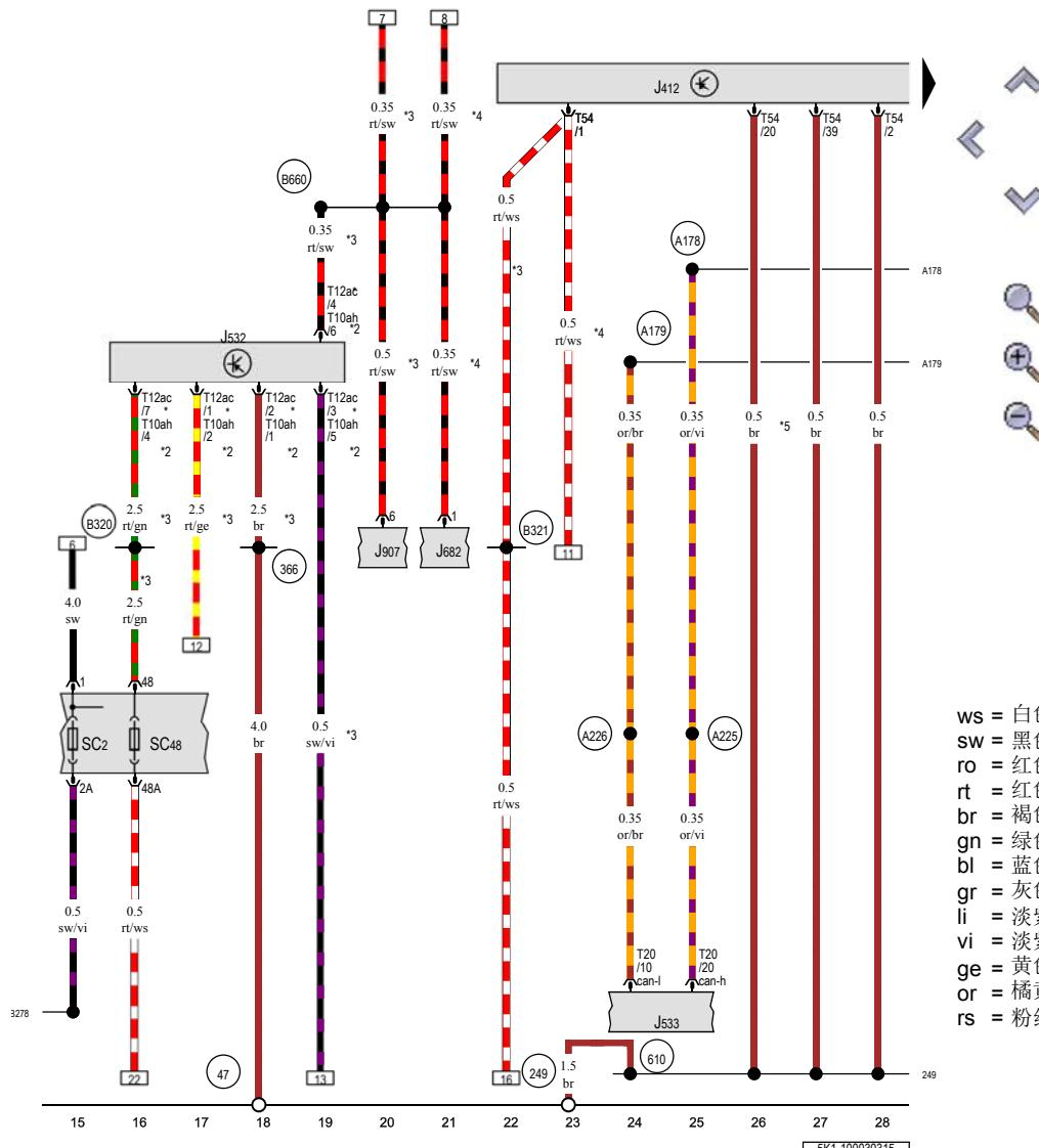
移动电话操作电子装置控制单元, 稳压器, 数据总线诊断接口, 保险丝架 C 上的保险丝 2, 保险丝架 C 上的保险丝 48
