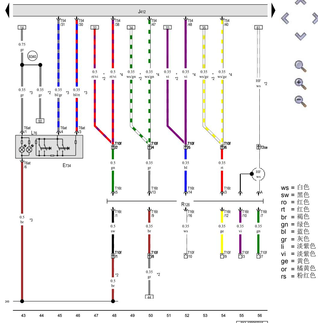
电子通信系统按钮模块, 移动电话操作电子装置控制单元, 电话固定支架
